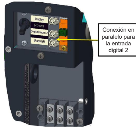
Figura 18 – Conexión en paralelo para el interruptor de puerta (También se usa para la sincronización del deshielo si se configura)
